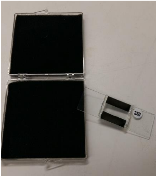
그림 6: 샘플 박스 및 Ti-코팅된 Fabry-Perot(FP) 에탈론 1개(설명용으로 이 그림의 샘플 번호는 #250)
