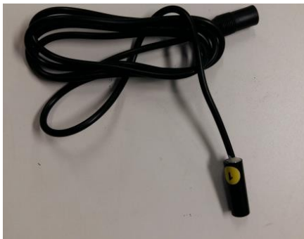
그림 2: 650nm 파장에서 0.5mW 출력의 레이저 다이오드(클래스 II)
