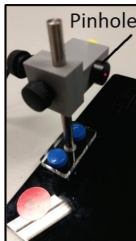
그림 12: 핀홀이 부착된 레이저 다이오드.
