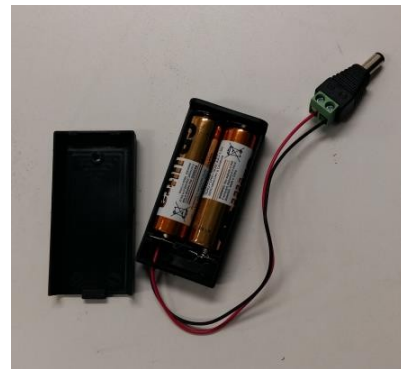
그림 3: 2×1.5V AA 배터리 레이저 다이오드용 콘센트 플러그가 포함된 배터리 팩
