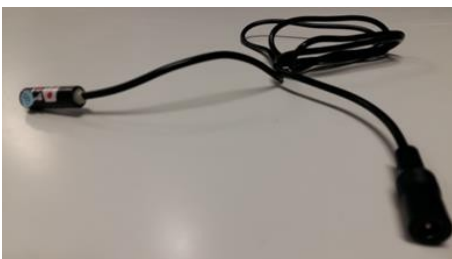
그림 6: 650nm 파장에서 0.5mW 출력을 내는 레이저 다이오드(클래스 II).
