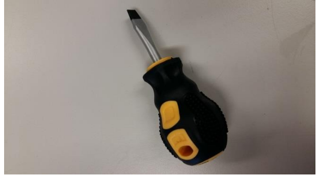
그림 7: 레이저 다이오드의 빔 크기를 조정하기 위한 일자 드라이버
