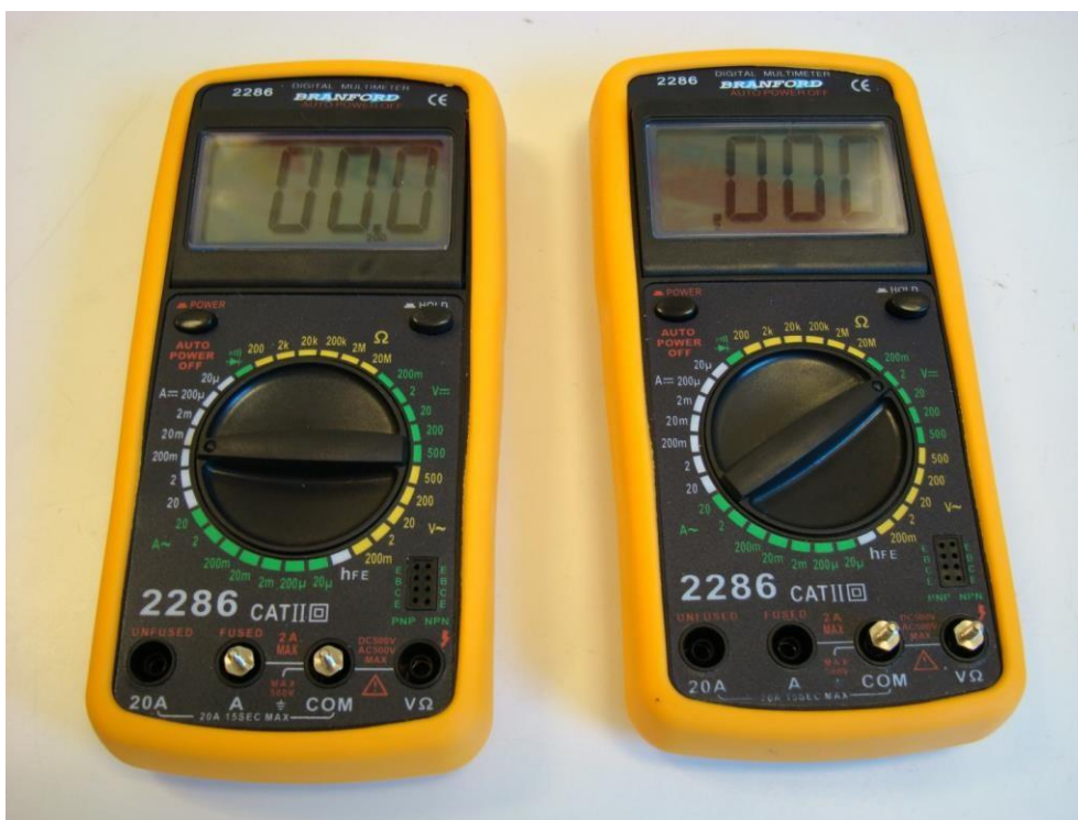
그림 2.3 전류계(왼쪽)와 전압계(오른쪽)로 각각 사용할 수 있는 단자가 장착된 멀티미터. 왼쪽 상단의 "전원"을 누르면 계측기가 켜집니다. 일정 유휴 시간이 지나면 기기가 자동으로 꺼집니다. 직류와 전압(=)은 물론 교류를 측정할 수 있습니다. 전류 및 전압(~). 전압계의 내부 저항은 측정 범위에 관계없이 10MΩ입니다. 전류계의 전위차는 측정 범위에 관계없이 최대 판독값에서 200mV입니다. 오버플로우가 발생하면 디스플레이에 "1"이 표시되며 더 높은 측정 범위를 선택해야 합니다. 측정을 정지하려는 경우를 제외하고는 "HOLD" 버튼(오른쪽 상단 모서리)을 누르지 마세요.
