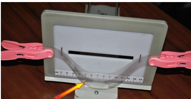
그림 3B 유연한 플라스틱 스트립을 화면에 고정하기.
