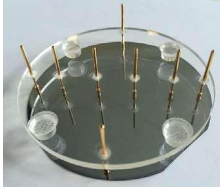
그림 3: 금속 코팅 실리콘 웨이퍼의 4PP 장치. 원형 웨이퍼의 오른쪽에 절단된 부분을 주목하세요. 이 컷을 플랫이라고 합니다.
