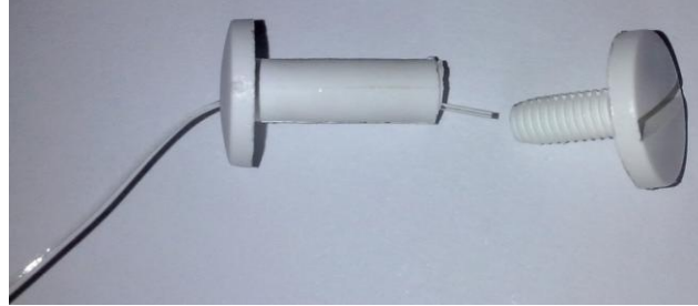
그림 6. 고정 나사에 TPU 나사산 장착하기.
